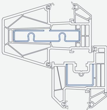
Pfosten- / Riegelverbindung
