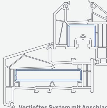
Vertieftes System mit Anschlag für Montage an Blindzarge
